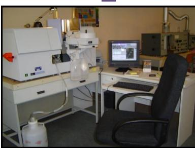
Atomic-absorption spectrometer: AAnalyst 800 (Perkin Elmer, USA)
